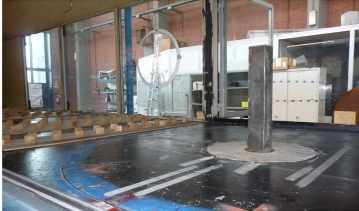
Figura 2: modello edificio regolare montato su bilancia HFFB in galleria
