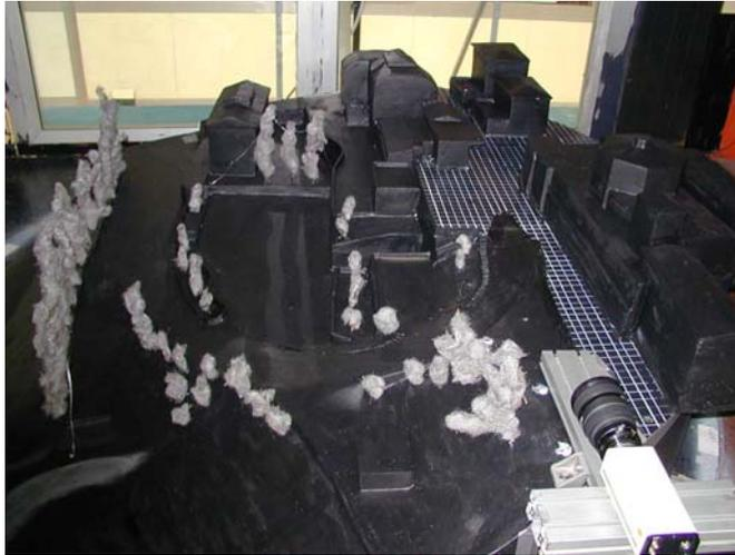
Figura 1. Vista del modello in galleria del vento.
