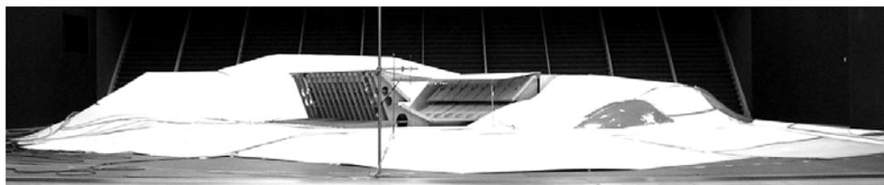
Figura 1. Modello 1:70 dello stadio di Braga completo dell'orografia in galleria del vento
