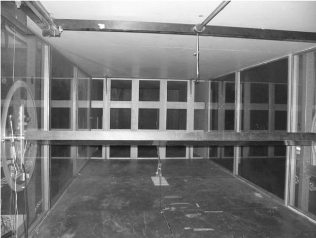
Figura 3. Griglia di legno utilizzata per la generazione della turbolenza
