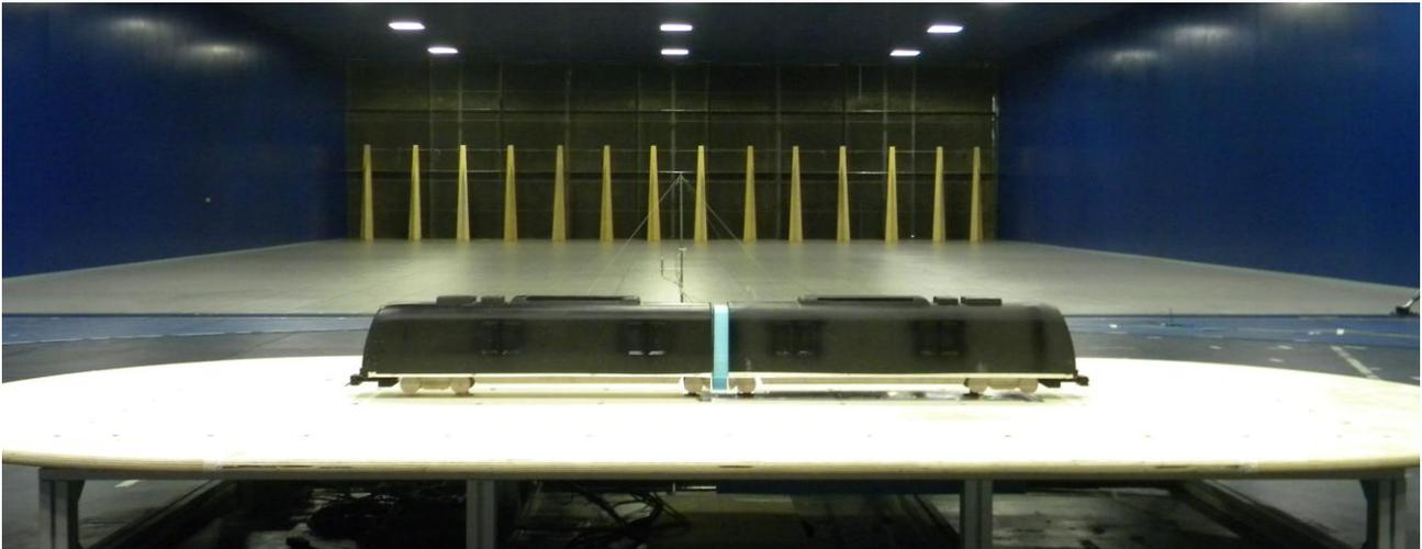
Figura 1. Modello in scala 1:15 del convoglio nella camera di prova a strato limite.
