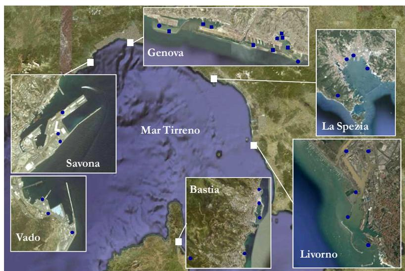
**Figura 1.** Posizione degli anemometri ultrasonici installati nei cinque porti dell'Alto Tirreno coinvolti nel progetto: strumenti già installati e finanziati dal progetto (pallini); strumenti in fase di installazione presso il Porto di Genova (quadratini).
