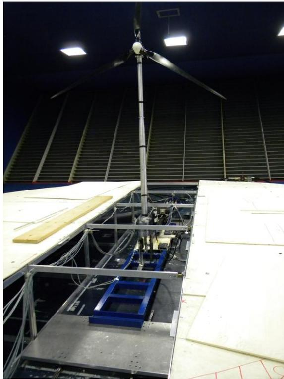
**Figure 1.** Set-up sperimentale per prove in galleria del vento a moto imposto.
