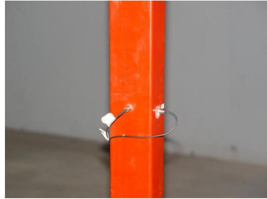
Fig. 4. Accelerometers
