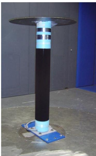
**Figura 1:** Set-up sperimentale per la caratterizzazione dei tessuti
