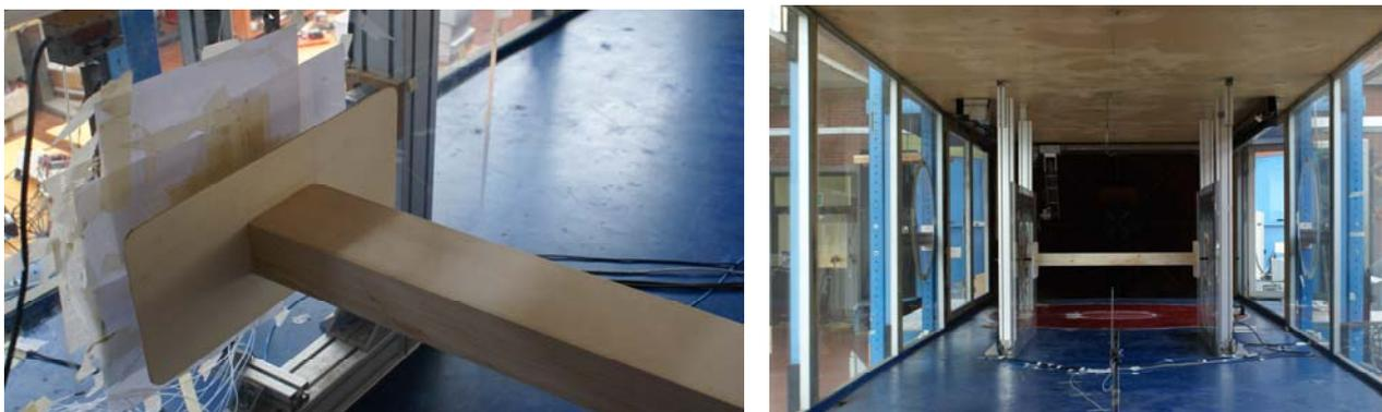
Figura 2. Modello sezione all'interno della camera di prova della galleria del vento: vista dall'alto (sinistra), vista frontale (destra).
